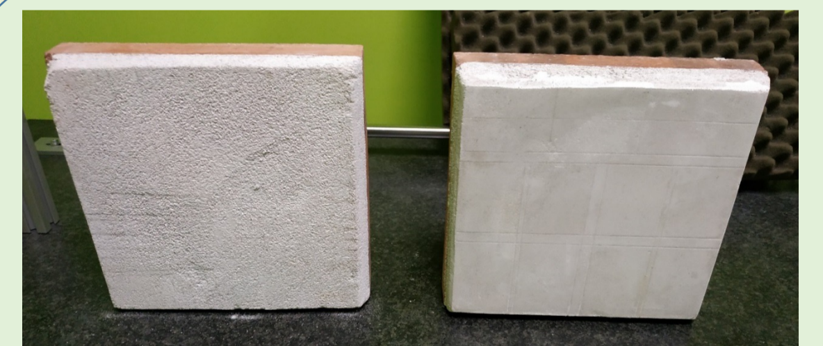
Provini di laboratorio durante l'imbibizione con acqua
